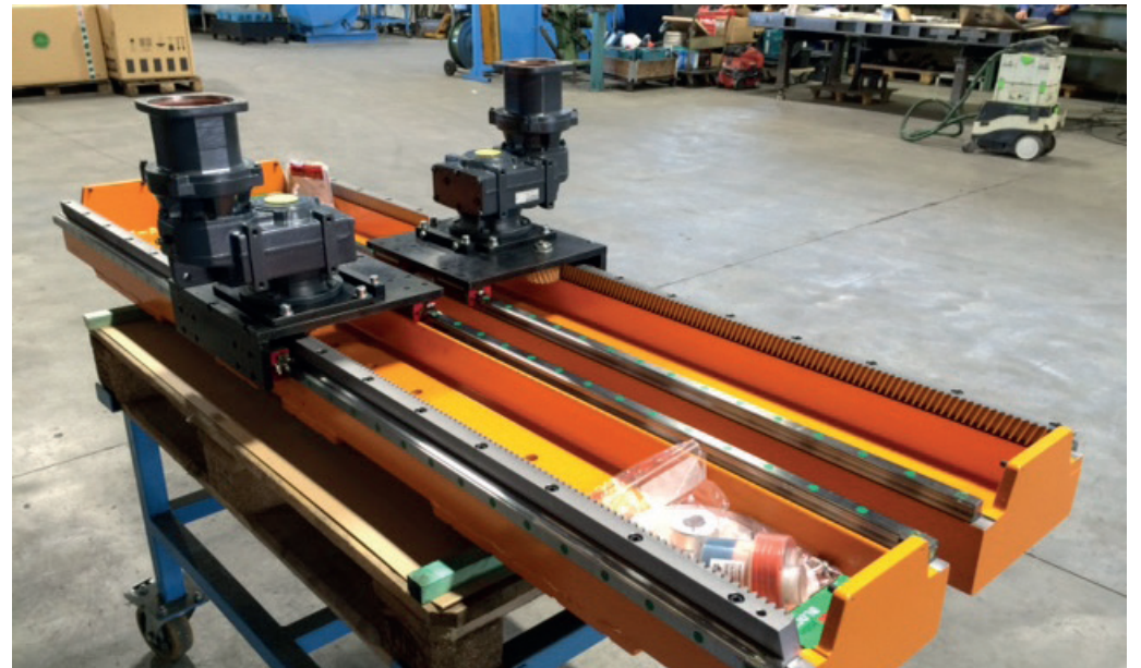
Linear module with rack and pinion Linear Module mit Zahnstange und Ritzel
