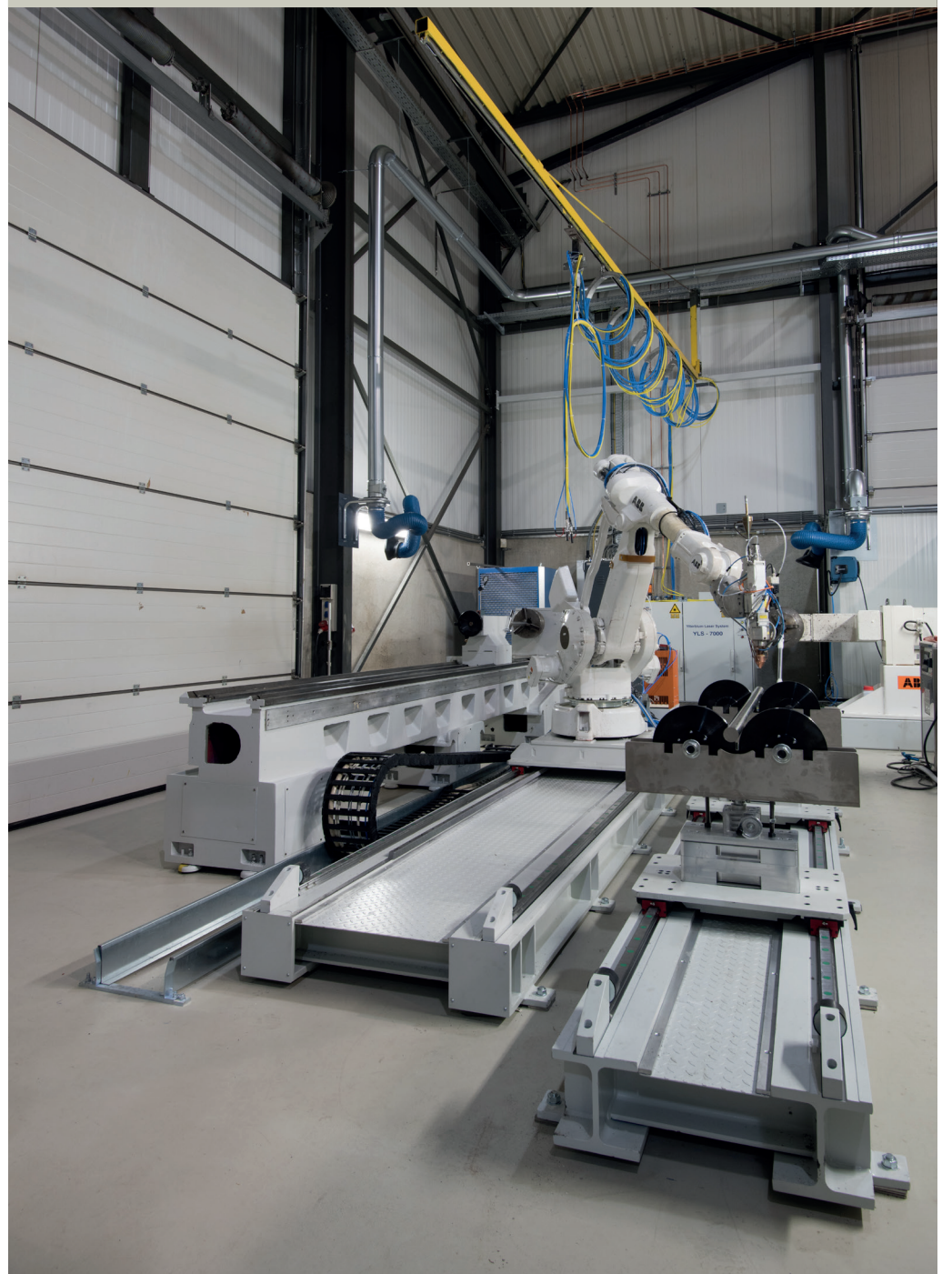
ABB FT45-Special robottrack with robot IRB440 FT45-Spezielle Verfahrachsen für ABB Robot IRB440
